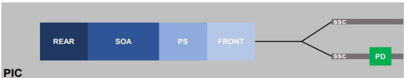
FIGURE 59: BREAKDOWN OF THE DBR LASERS CONSTITUENT COMPONENTS
